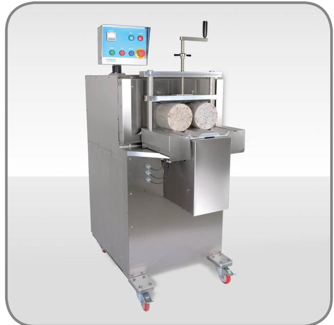
La mobilité de la machine est obtenue à l'aide des roues intégrées, et tous les composants du système sont accessibles en toute sécurité pour un entretien facile.
