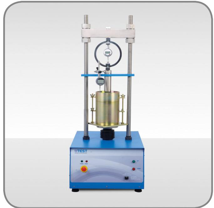
La machine d'essai CBR est fournie avec:
