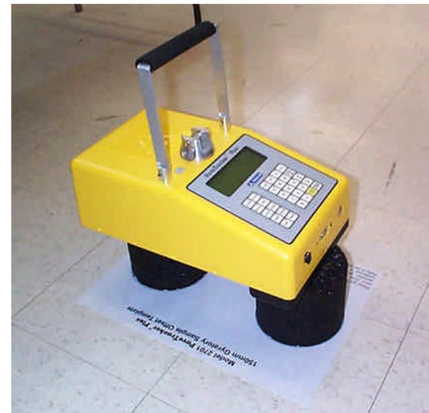
Le 2701B est positionné sur les éprouvettes et des mesures sont effectuées.
