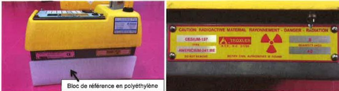
A l'intérieur de l'appareil, entourant l'emplacement de la source d'Am-Be, est placée une étiquette spécifique à la source de neutrons indiquant son numéro de série et sa date de calibration.
