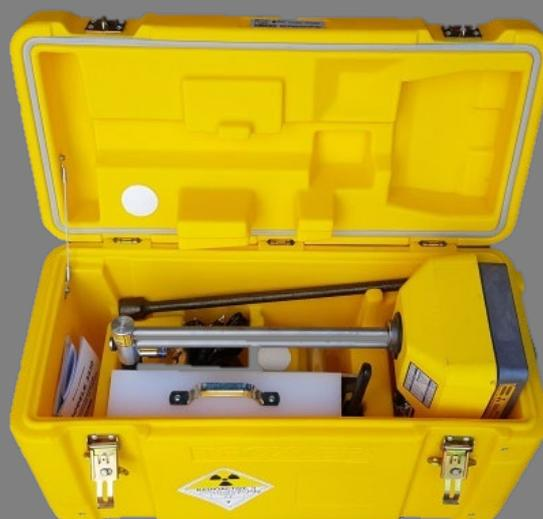
Gammadensimètre – humidimètre TROXLER
