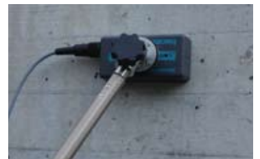
Canne télescopique pour sonde universelle ou ScanCar
